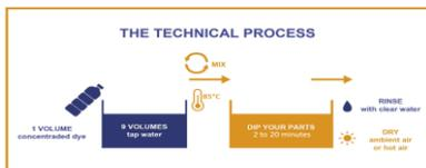
Préparez un bain de teinture en diluant les colorants liquides PCL4 avec de l'eau. Faites-le chauffer.
